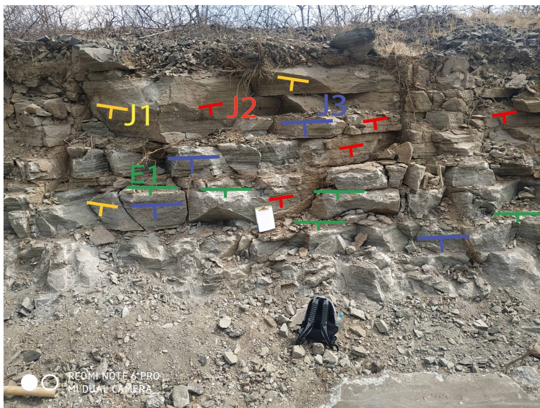
Figura 8. Talud 2, Estación T02_EGM01. Se observan 3 familias de diaclasas (J1, J2 y J3) y el plano de estratificación (E1) (Elaboración propia).
