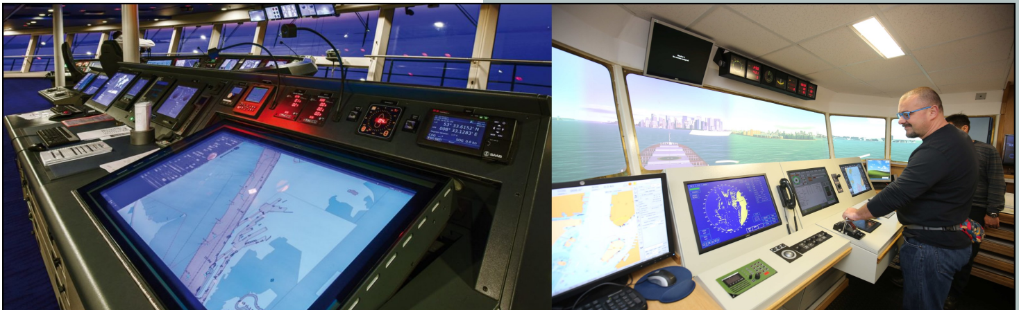
Figura 24. Sistema ECDIS en el puente de mando / ECDIS on the bridge.
