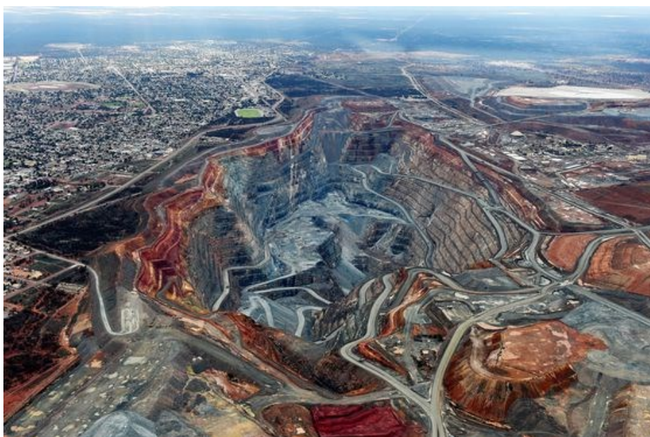
Figura 15. Aunque las minas son estructuras hechas por el hombre, funcionan como reflectores naturales ya que no es necesario instalar ningún dispositivo para obtener información coherente de la fase y amplitud, debido a su composición, condiciones y orientación.
