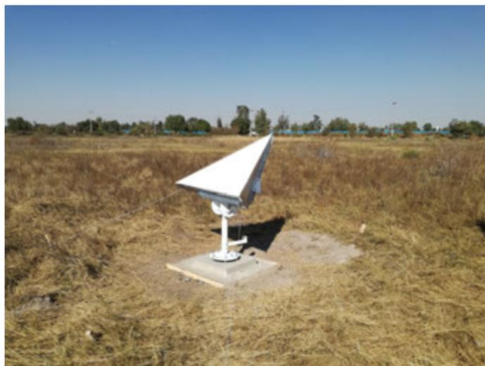
Figura 14. Reflector triédrico para retrodispersión persistente de la señal radar en un sitio con alta decorrelación.
