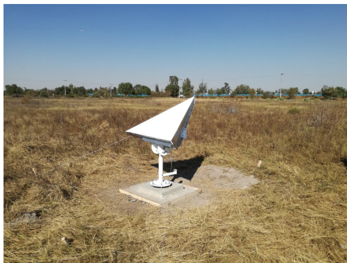
Figura 14. Reflector triédro para retrodispersión persistente de la señal radar en un sitio con alta decorrelación.
