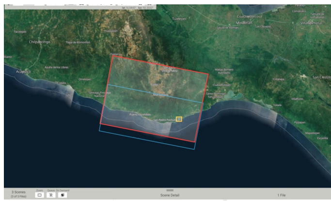
Figura 5. Huella de cobertura de las imágenes radar Sentinel-1A/B sobre la zona del sismo.
